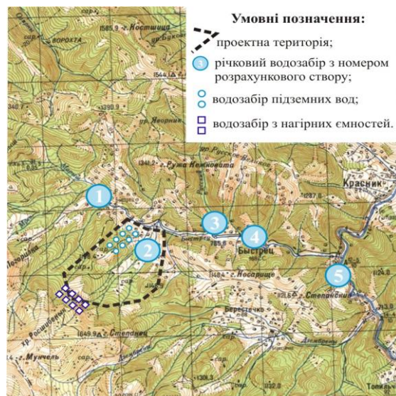
Рис. 1. Карта-схема варіантів технічних рішень водопостачання туристичного комплексу «Чорногори».
