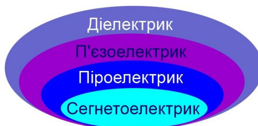
Рис. 1. Діелектричні, п'єзоелектричні, піроелектричні та сегнетоелектричні матеріали
