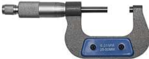
Рис.1 – Мікрометр механічний. Ціна поділки 0,01мм
