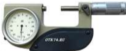
Рис.3 – Мікрометр індикаторний. Ціна поділки 0,001мм
