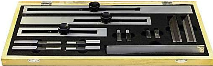
Рис.2 - Набір приладдя до плоско паралельних кінцевих мір довжини ПК-2
