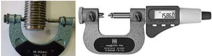
Рис.5 – Мікрометр різьбовий (вимірюється середній діаметр різьби)
