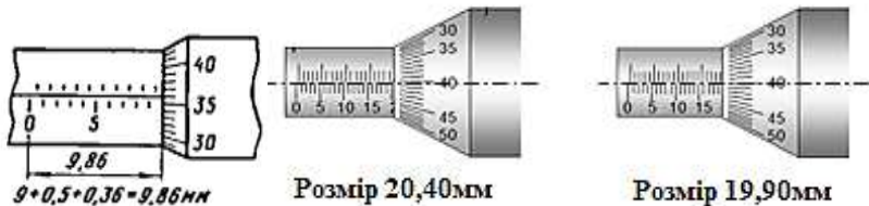
Рис.9 – Відлік розмірів мікрометром
