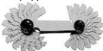
Рис.4 – Різьбомір (набір різьбових шаблонів з кроком від 0,4 до 6мм)
