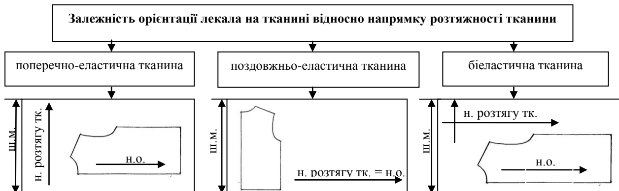
Рисунок 2- Схема орієнтації лекала відносно напрямку розтяжності матеріалу
