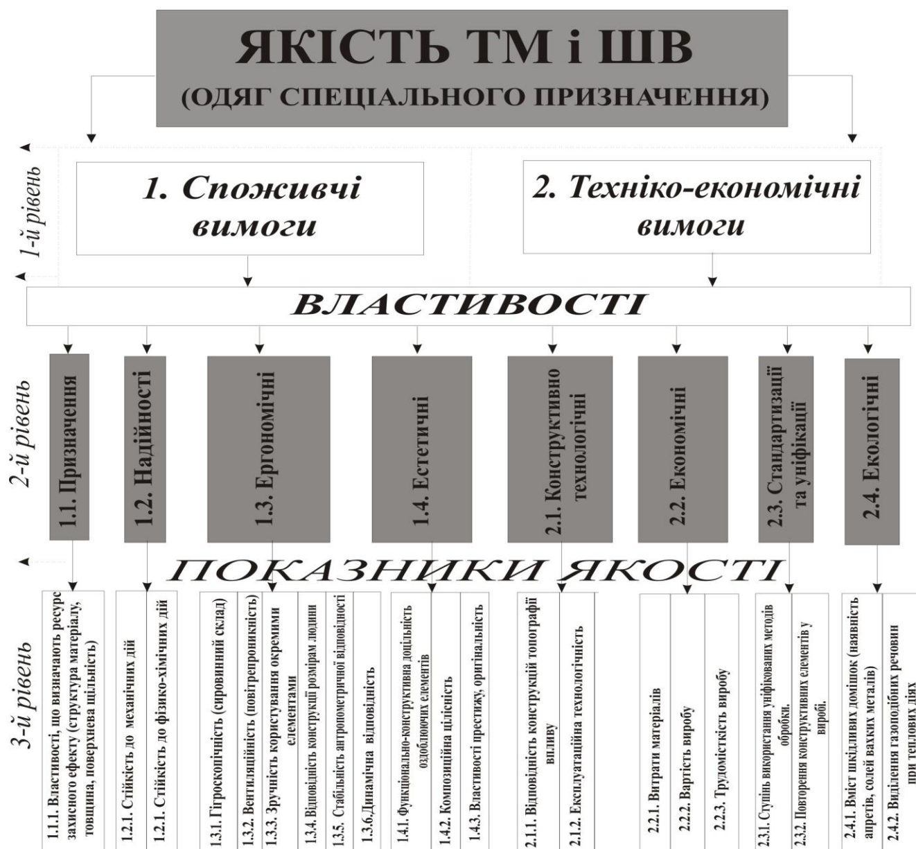
Рисунок 3.1– Структурно-ієрархічна схема показників якості для спецодягу, який захищений від механічних дій
