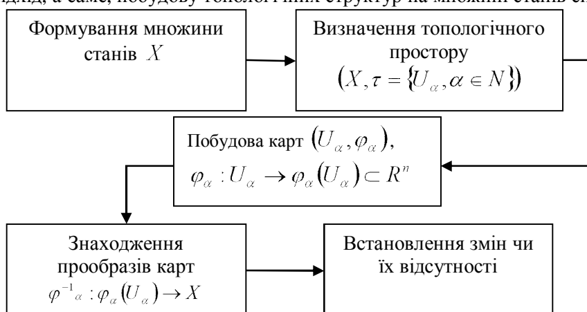
Рис. 1. Схема топологічного методу моделювання структури динаміки
