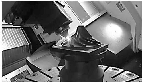
Рис. 1. Обробка деталі на машині DMG Lasertec 65 3D Hybrid
