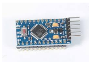
Fig. 3. Arduino Pro Mini 5B16 MHz ATmega328.
