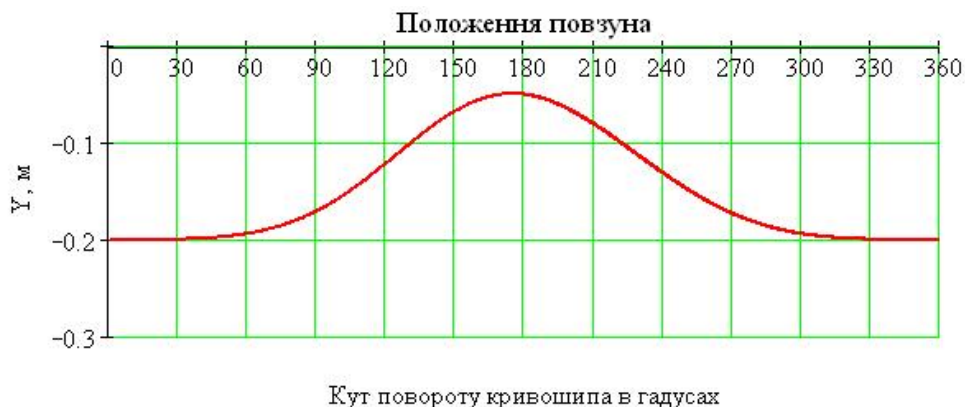
Рис. 2. Графік залежності положення пресувального повзуна від кута \alpha_1 .
