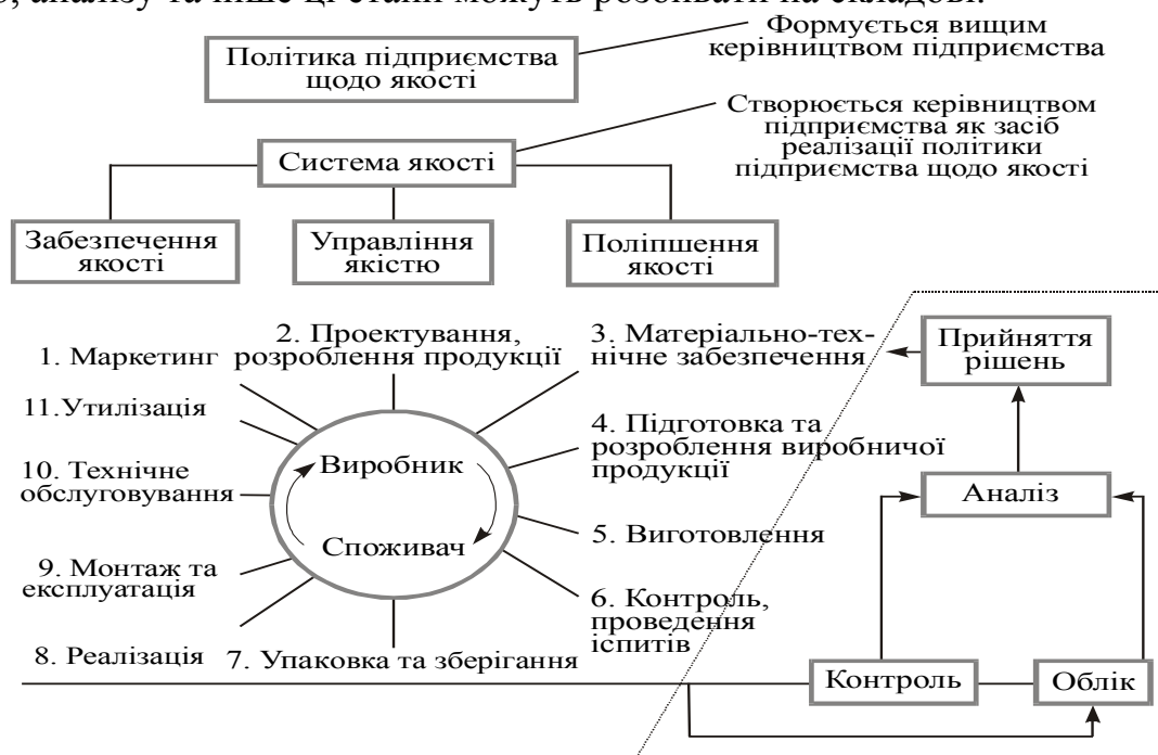
Рис. 1 «Петля якості» або типові стадії життєвого циклу, на яких забезпечується якість продукції
