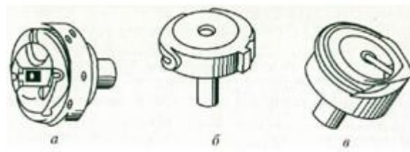
Рис. 3.2 – Види обертових (ротаційних) човників): а) з горизонтальною віссю обертання; б) з вертикальною віссю обертання; в) з похилою віссю обертання.
