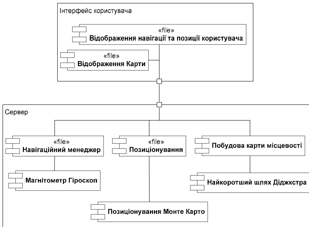
Рис. 8. Архітектура системи GROPING [36]
