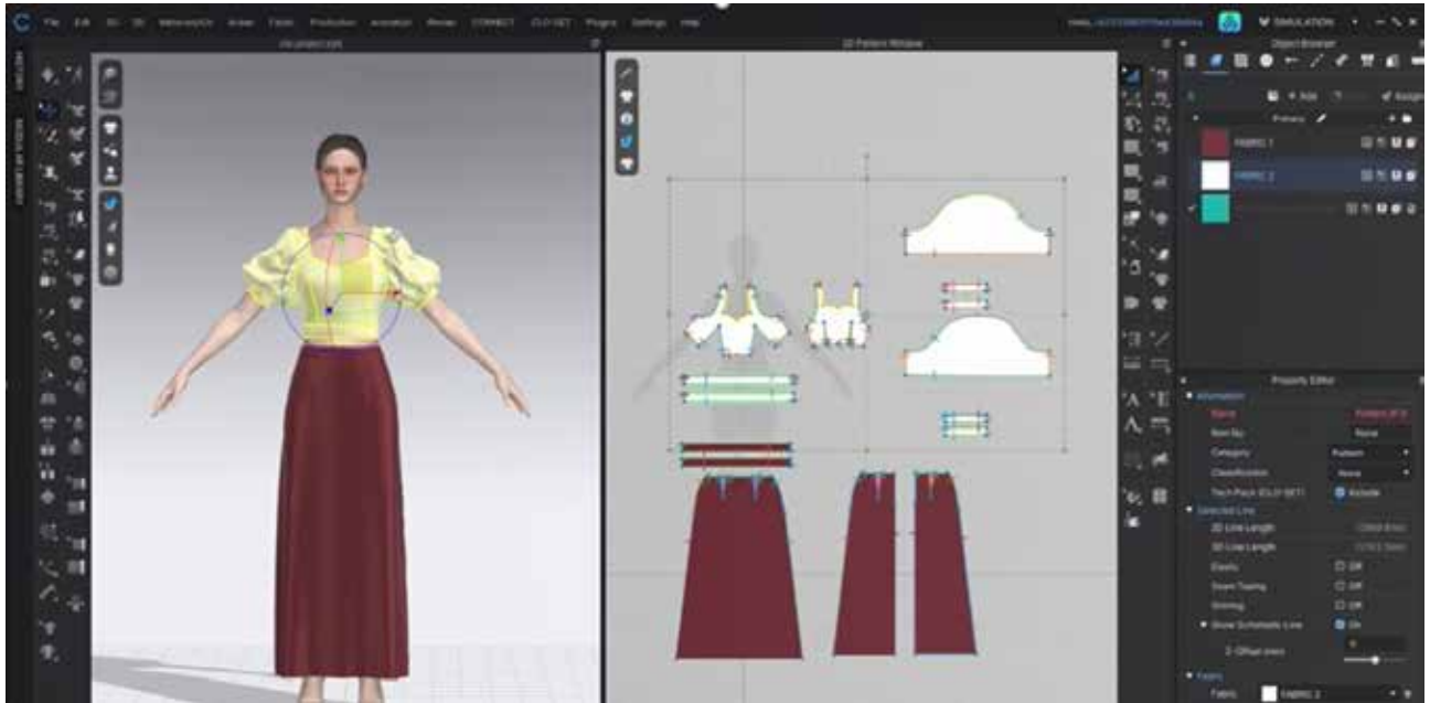
Рис. 2. 2D та 3D зображення спідниці та блузи в програмі clo3D (робота здобувача ОП «Технології легкої промисловості» Д. Павличук)
