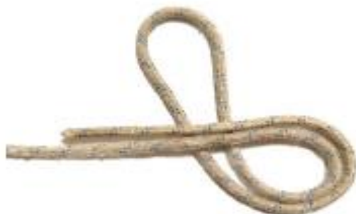
Рис. 3. Утворену подвійну мотузку вигинаємо в кільце, вигинаємо по годинниковій стрілці, утворюючи перше кільце вісімки. Ходова петля проходить під корінними кінцями.
